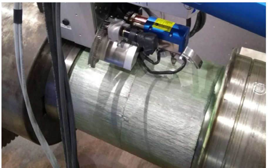
▲ Bild 8. Fertige Impuls-Laserstrahlschweißung bei der finalen Eigenspannungsanalyse (Bilder: DSI)
