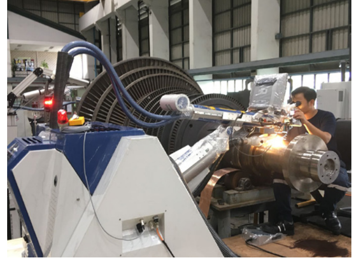
◀ ▲ Bild 6. Schweißen am Turbinenrotor vor Ort in Thailand
