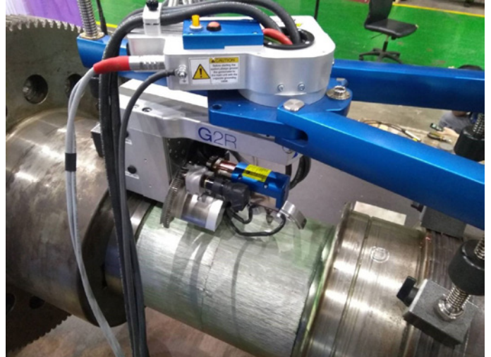
▲ Bild 5. Vor dem Schweißen und während des Schweißens angebrachtes Messgerät zur Eigenspannungsanalyse der Turbinenwelle
