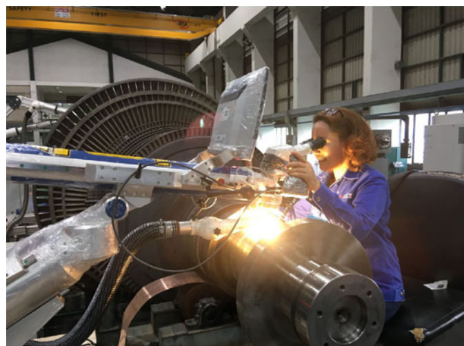
◀ ▲ Bild 6. Schweißen am Turbinenrotor vor Ort in Thailand
