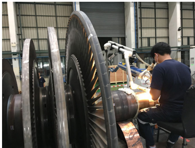
▲ Bild 5. Vor dem Schweißen und während des Schweißens angebrachtes Messgerät zur Eigenspannungsanalyse der Turbinenwelle
