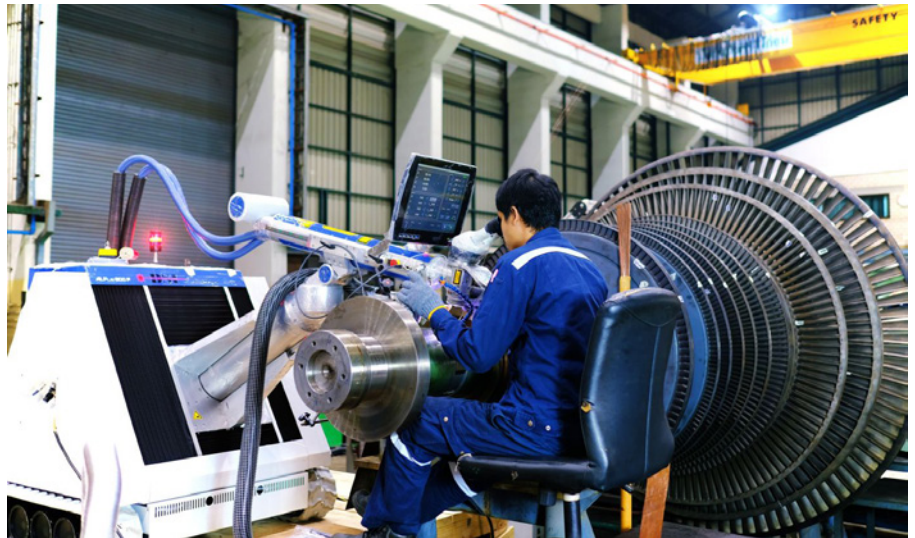
▲ Bild 3. Impuls-Laserstrahl-Schweißmaschine im Schweißensatz am Turbinenrotor in Thailand
