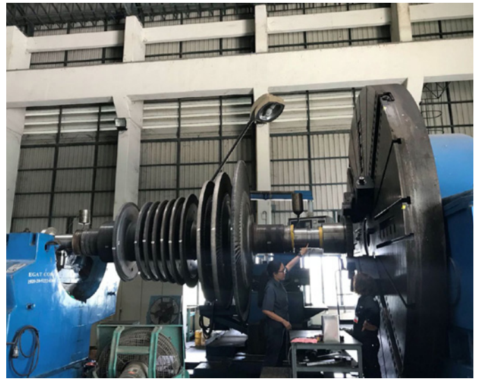
▲ Bild 1. Einbringen des Turbinenrotors in die Kopfdrehbank zur mechanischen Vorbearbeitung der schadhaften Flächen
