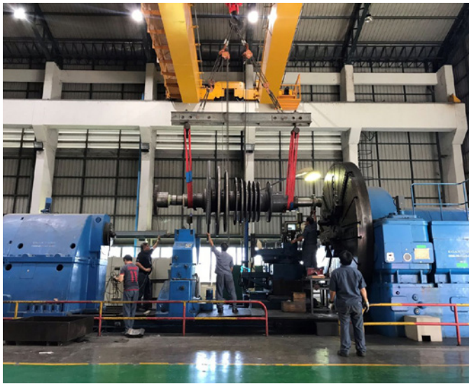
▲ Bild 1. Einbringen des Turbinenrotors in die Kopfdrehbank zur mechanischen Vorbearbeitung der schadhaften Flächen
