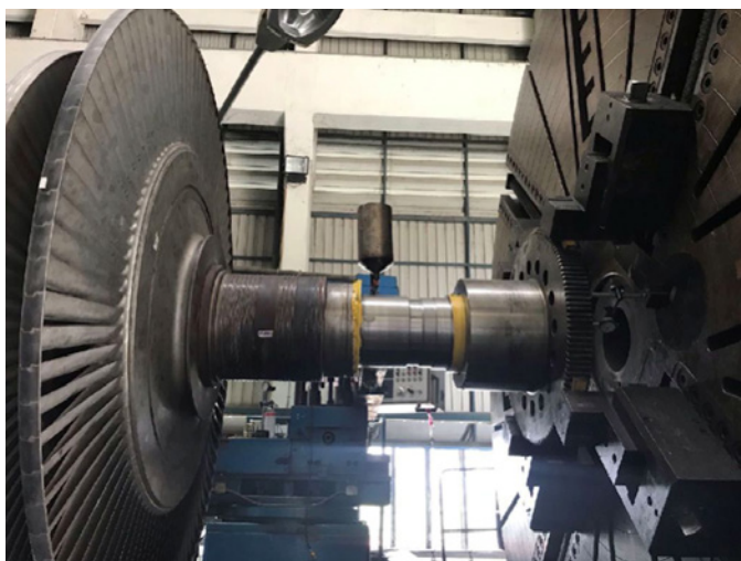
▲ Bild 4. Mechanisch für die Reparaturschweißung vorbereitete Turbinenwelle
